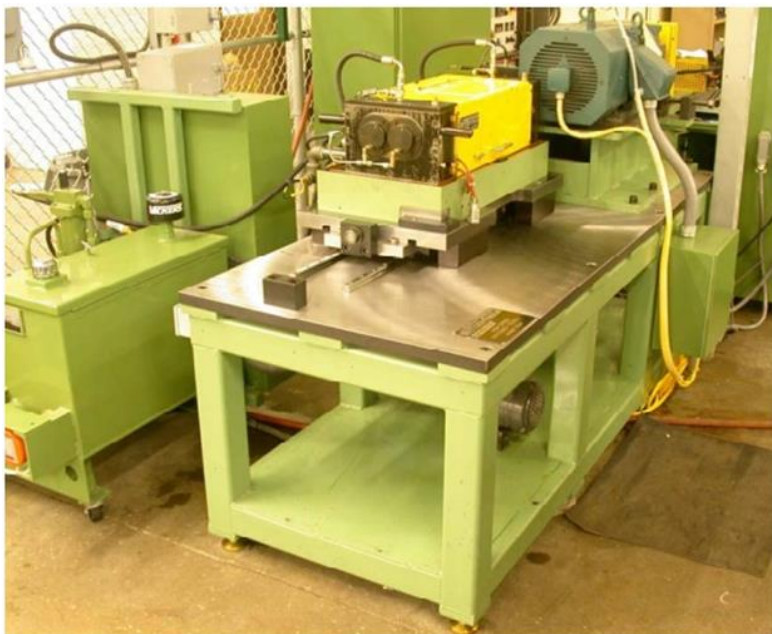
Slika 6. Uređaj za ispitivanje stepena iskorišćenja zupčanika sa velikim brojem obrtaja Izvor: Development of a generaliyed mechanical efficiency prediction methodology for gear pairs , 2005, p. 165
